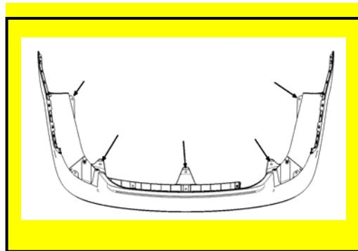
9. 拆卸与后轮罩衬板搭接的2个螺钉。
