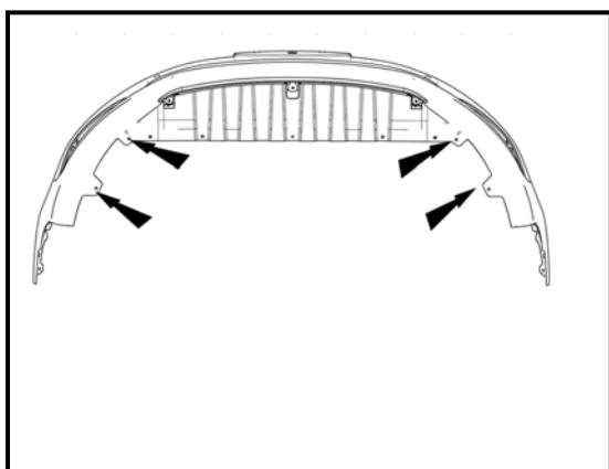
10. 拆卸保险杠左右两侧固定螺钉。
