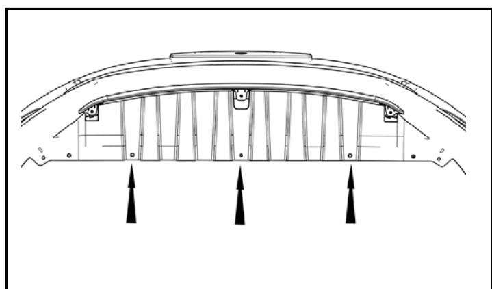
9. 拆卸保险杠底部两侧共4个塑料卡扣。
