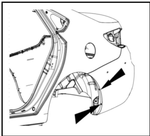
10. 拆卸与车身搭接螺栓左右各3个。此几处螺钉安装于行李箱内，拆卸行李箱侧地毯后可见。
